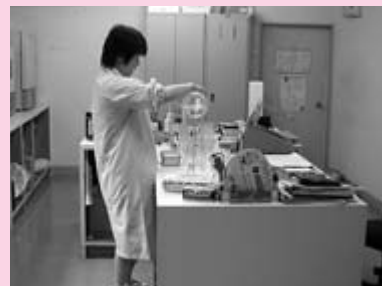
品質管理検査 一般細菌数、ブドウ球菌、サルモネラ菌、腸炎ビブリオの陽性検査、塩分濃度。結果は、ロット番号で管理され保存される。
