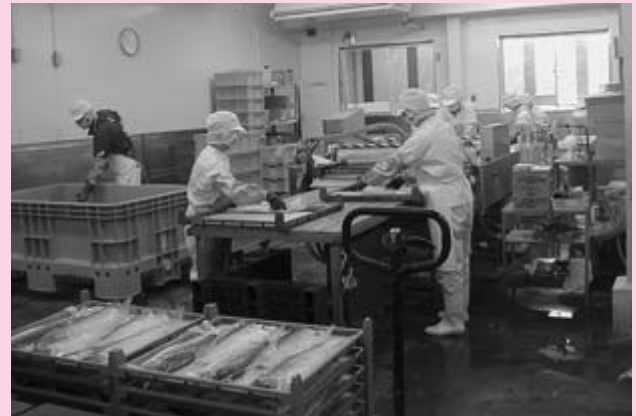
定塩フィレ加工 ドレスの状態のサケをフィレに加工後、塩処理し真空パックする。
